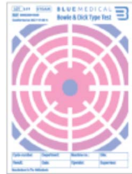
Fehler! Mögliche Ursache: zu kurze Sterilisationszeit oder zu niedrige Temperatur
