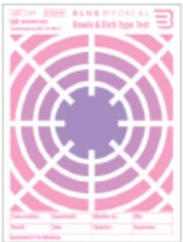
Gescheitert! Mögliche Ursache: Vorhandensein von Luft aus nicht kondensierbaren Gasen, schlechte Luftentfernung, Leckage oder Gas im Dampf.
